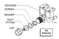
Fig. 16 Fill Solenoid
