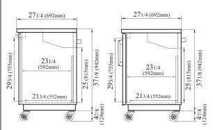
TBB-3SBD-N6 & TBB-3SGD-N SIDE VIEW
